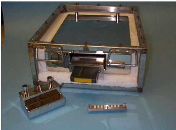
溶体化焼入れ時効炉工程測定用
