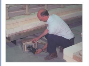
Datapaqキルン遠隔測定システムは、先進的な 無線データ伝送技術を用いて情報を送受信する ため、大多数のトンネルキルンでの使用に最適 です。データの完全性を確保するために、デー タは伝送されると同時に、ロガーにも保存され ます。
